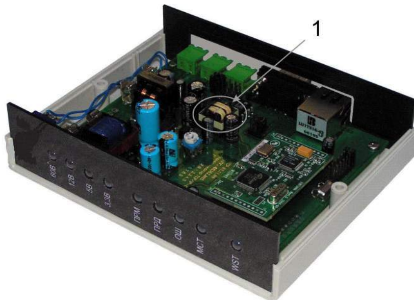
Рисунок 1: Общий вид коммуникатора TCP/IP
