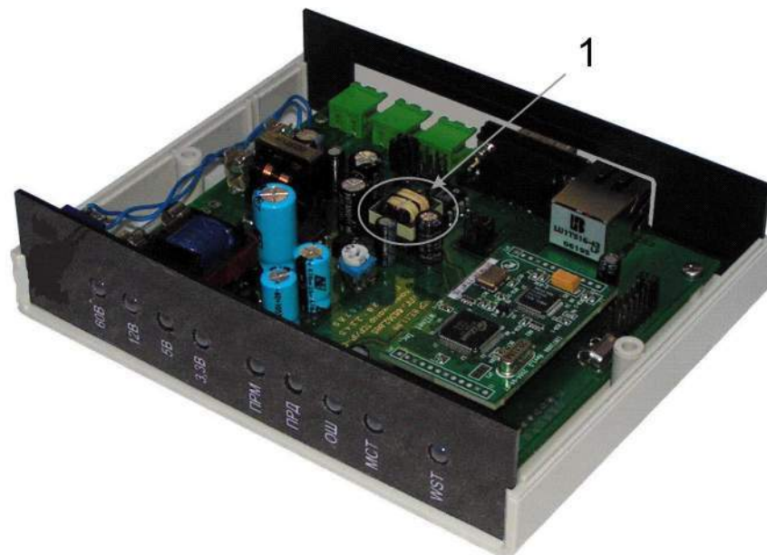
Рисунок 1: Общий вид коммуникатора TCP/IP
