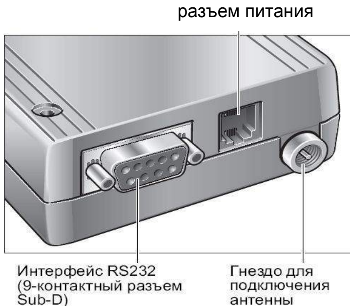
Рисунок 4 – Назначение разъёмов на терминале TC35 (MC55).
