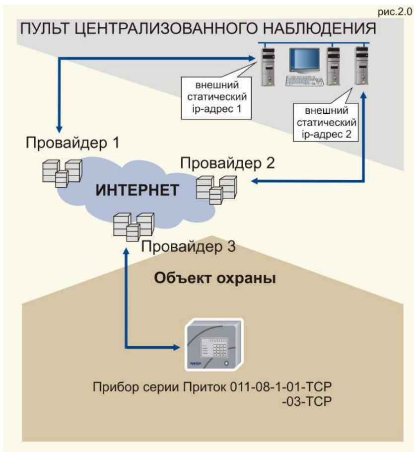
Рисунок 4. Схема подключения приборов серии Приток-Интернет к ПЦН.
