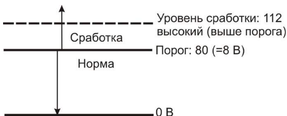
Рисунок 7 - Высокий уровень сработки входа «Зажигание».
