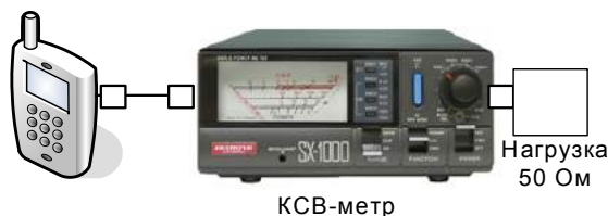
Рисунок 5. Измерение мощности P_1
