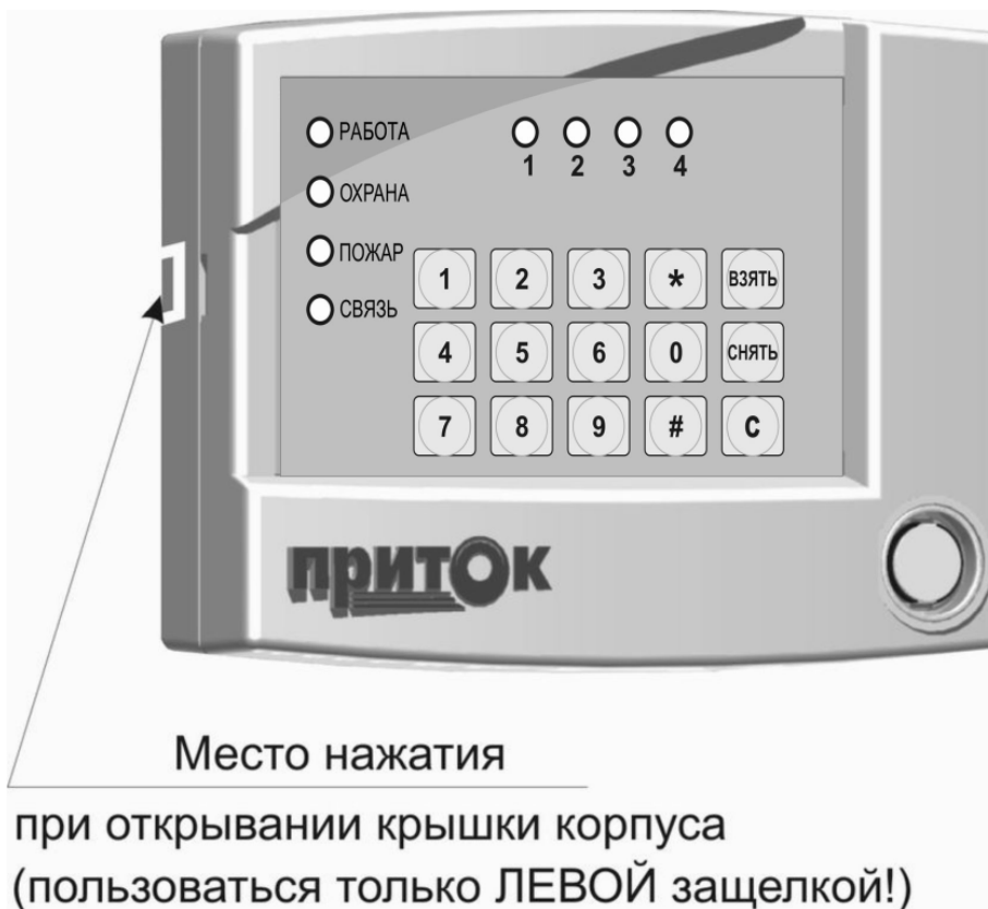
Рисунок 1. Вскрытие корпуса коммуникатора.
