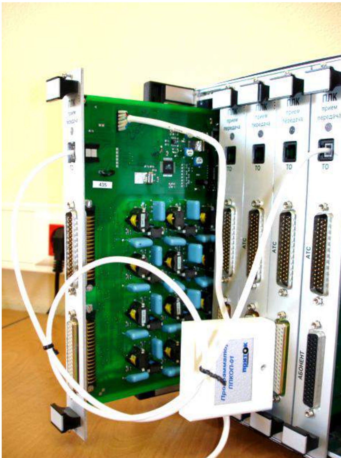
Рисунок 3.4 – Программирование платы КЛР без полного извлечения из корзины
