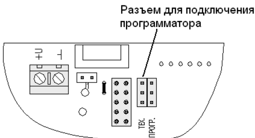
Рисунок 2. Подключение программатора прибору выпуска с июля 2010 года.
