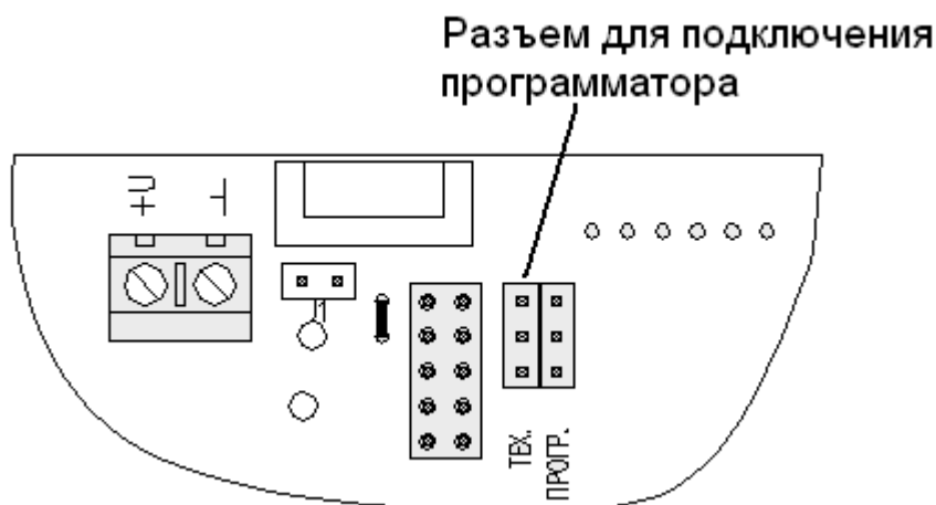
Рисунок 8. Подключение программатора к прибору с двумя SIM-картами.
